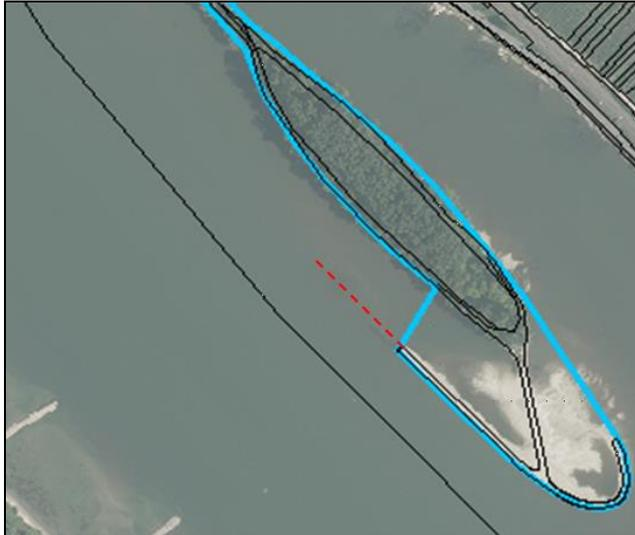
Abbildung 5: Schematische Darstellung zur Maßnahme Verlängerung des bestehenden Leitwerks (rot gestrichelte Linie).
