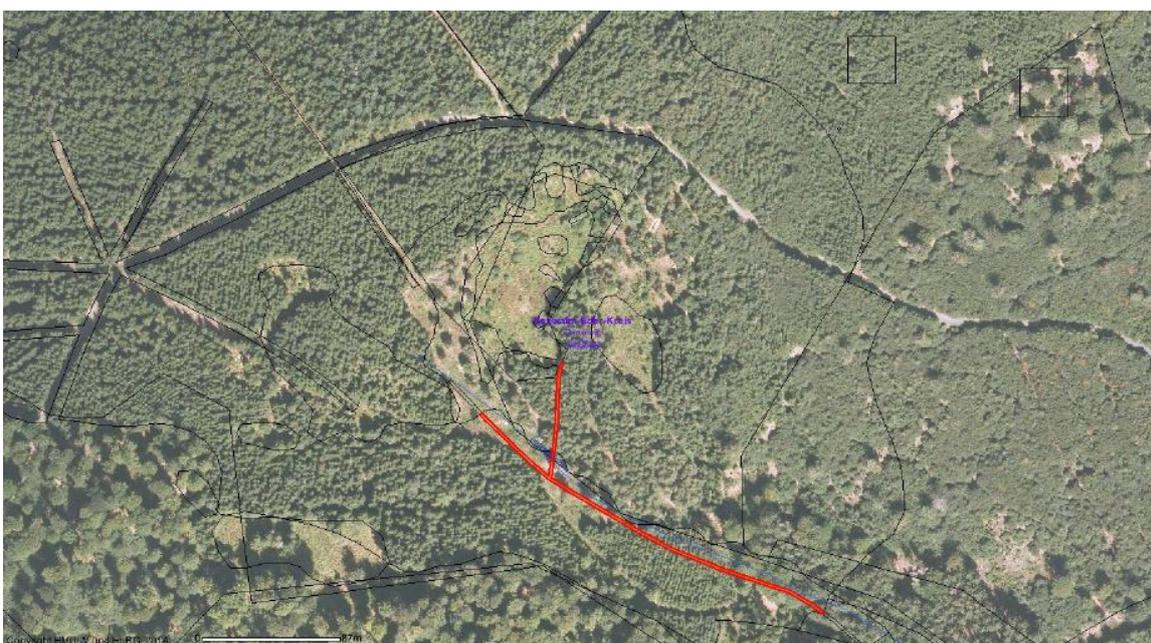
Abbildung 4: Darstellung der Erhaltungsmaßnahme: Einbau von Sohlschwellen
