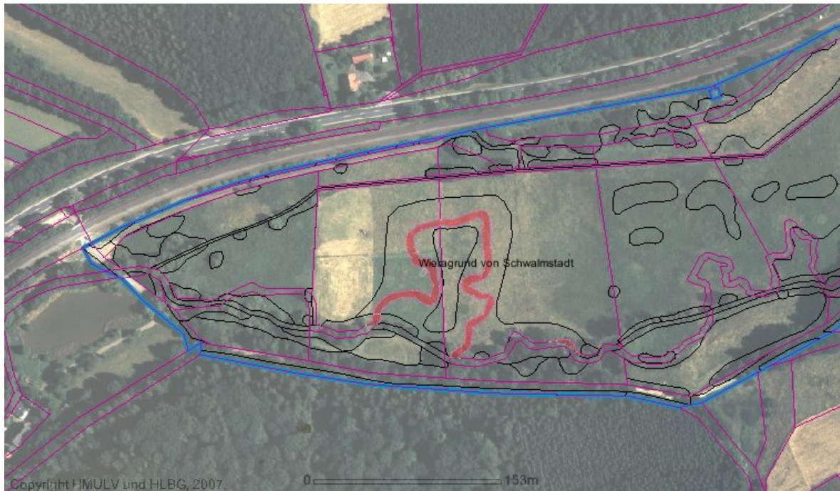
Abb. 9 Wiederherstellen eines Mäanders durch Ausbaggern des alten Bachbetts, Abtransport des Erdaushubs, Belassen eines ca. 40 m langen Altarmes
