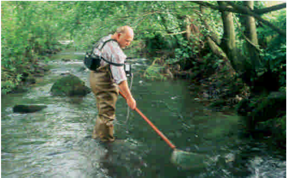
Abb. 2.3: Fischbestandserfassung mittels tragbarem Elektrofischereigerät in der Äschenregion
