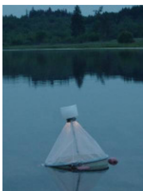
Abb. 4: Auftauch-Lichtfalle im Reichloser See. Foto: Verfasser
