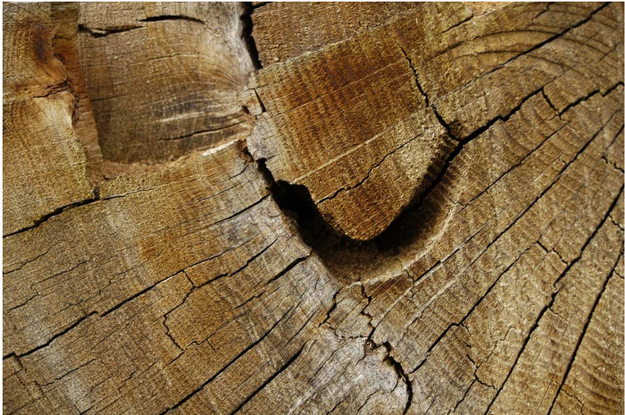
Abb. 2: Bohrgänge in Eichenstamm aus dem Firnsbachtal von 2007
