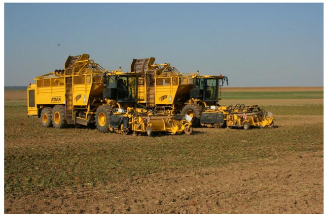
Während der geradezu possierlich anmutende Mähdrescher aus den 60er-Jahren gerade mal eine Arbeitsbreite von weniger als zwei Metern aufweist und in beschaulicher Geschwindigkeit über den Acker staubte, bearbeiten inzwischen Maschinen in der Größe eines Eisenbahnwaggons (hier zwei Rübenroder) die Felder. Mähdrescher kommen inzwischen auf Mähbreiten von 10,5 Metern und eine Leistung von nahezu 600 PS (Angaben nach Claas Deutschland) und fahren nicht selten GPS-gesteuert über den Acker.
