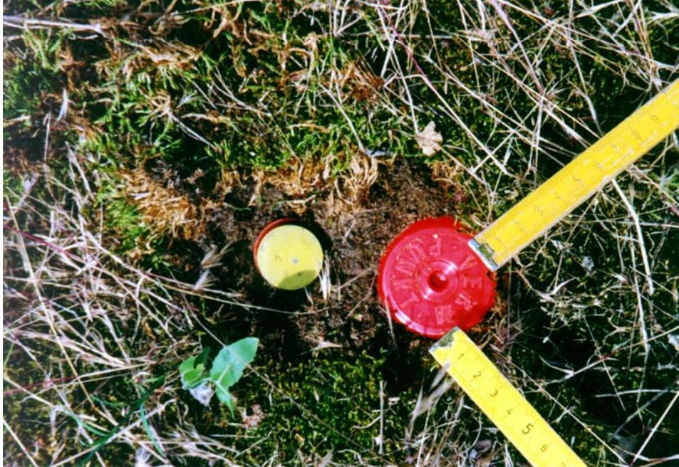
**Foto Nr. 1:** Markierungselemente an den Eckpunkten der Dauerbeobachtungsflächen: auf den Eckpunkten sitzt jeweils ein Rundstab aus Eisen, der mit einem roten Kunststoffdeckel (Aufschrift „Verm. Punkt“) versehen ist. Unmittelbar daneben ist (nach außen hin) zusätzlich je ein gelber Rundmagnet auf einem Plastikkegel platziert. Nur zur Aufnahme werden Zollstöcke an den Eckpunkten angelegt.
