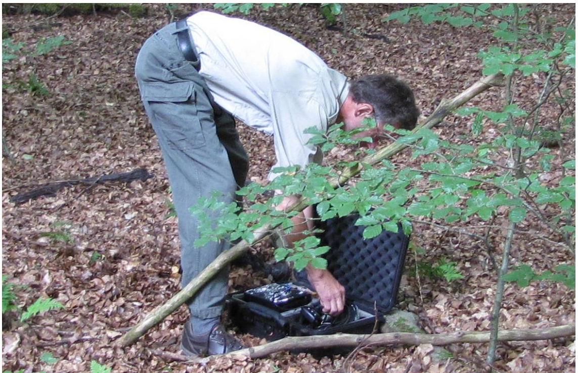
Standort der Fledermauserfassung am 26./27.07.2010. Das an einem Strauch befestigte Mikrofon ist mit dem in einem wasserdichten Koffer verstauten PC verbunden.
