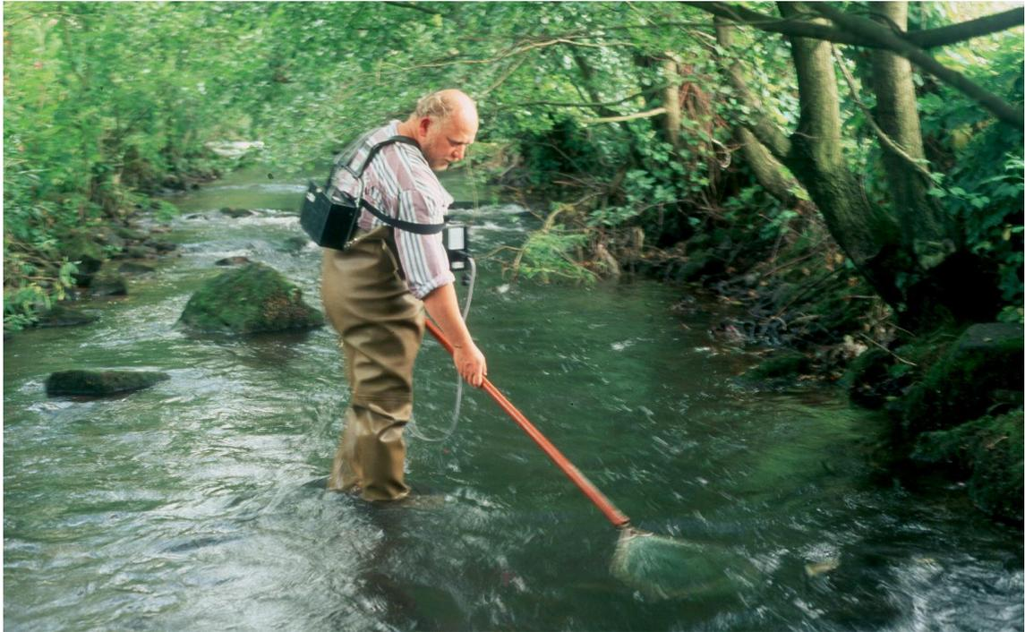
Abb. 7: Fischbestandserfassung mittels tragbarem Elektrofischereigerät
